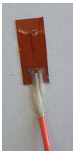
Cette jauge de contraintes à fibre optique à conception pelliculaire, développée par FTMesures et Opsens Solutions, rend possibles les mesures sur des matériaux inhomogènes, tels que les composites, ou sur des grandes pièces.
